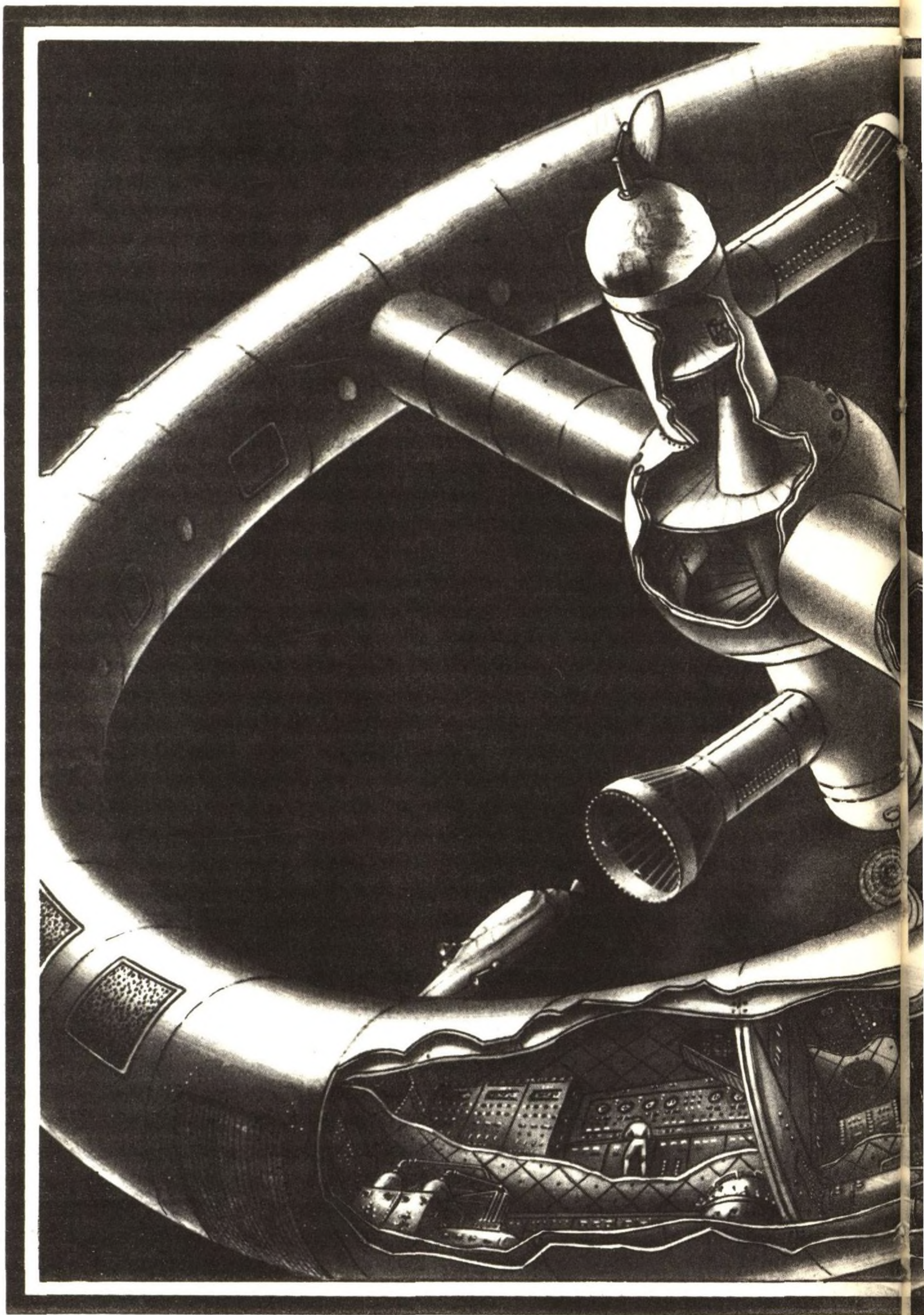
Крупная орбитальная станция на 200—300 человек. Вращением станции создается искусственная тяжесть.
